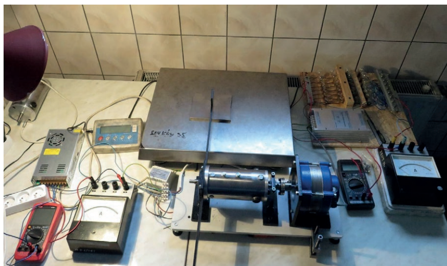
Rys. 6. Widok silnika na stanowisku badawczym (maszyna niebieska to generator obciążający silnik)
