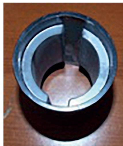
Rys. 1. Stojan typowego silnika komutatorowego z magnesami ferrytowymi
