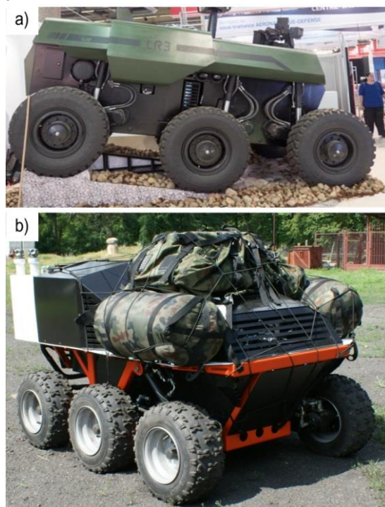
Rys. 2. Przykłady wolnobieżnych transportowych platform terenowych z hydrostatycznymi układami napędowymi: a) IAI's UGV [10], b) platforma ExMot
