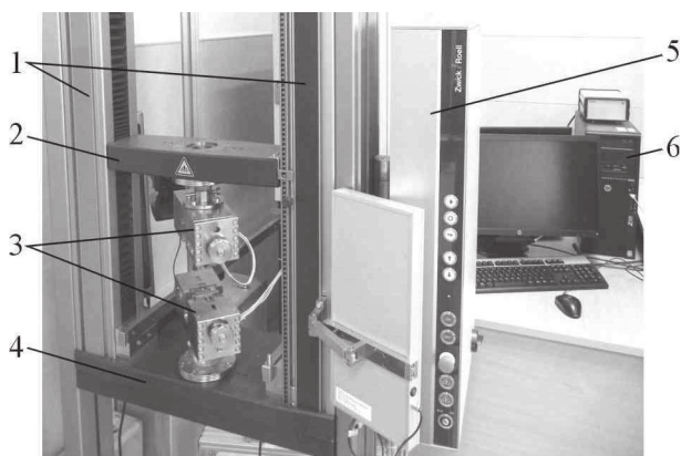
Rys. 6. Fragment maszyny wytrzymałościowej firmy Zwick Roell Z010. 1 – prowadnice, 2 – stół ruchomy, 3 – uchwyt próbki, 4 – stół nieruchomy, 5 – panel sterujący, 6 – stanowisko komputerowe
