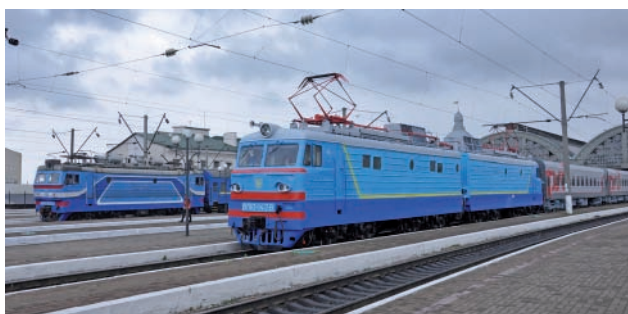
Rys. 8. Lwów Gł. jest stacją zmiany napięcia – poszczególne odcinki mają opcjonalną możliwość zasilania napięciem przemiennym lub stałym: WL40-1457-1 (1520 mm, 25 kV 50 Hz) z poc. dalekobieżnym do Kijowa (wagony UZ) i WL10-1478 (1520 mm, 3 kV DC) z poc. dalekobieżnym rel. Czop – Kijów – Moskwa (wagony RŽD) (28.04.2013 r.) [fot. M. Graff]
