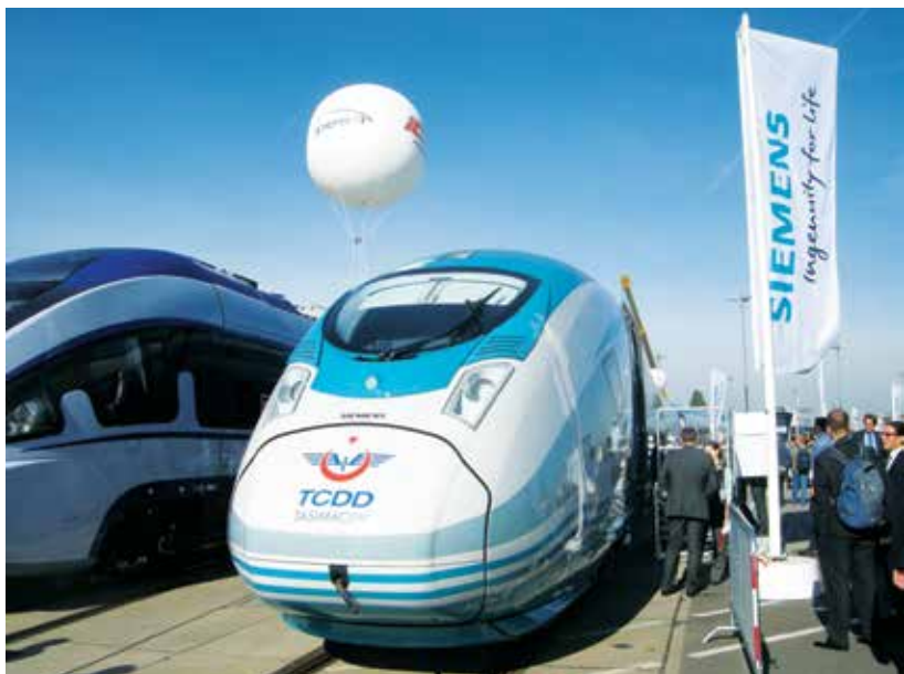
Pociąg dużych prędkości Velaro TR (Siemens) dla kolei tureckich (25 kV 50 Hz)
