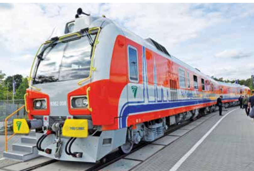
Dwuwagony pociąg diagnostyczny serii FMK-008 kolei węgierskich
