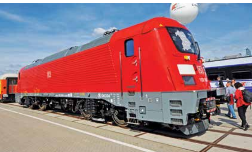
Lokomotywa elektryczna DB serii 102 (15 kV 16,7 Hz) wyprodukowana przez Škodę
