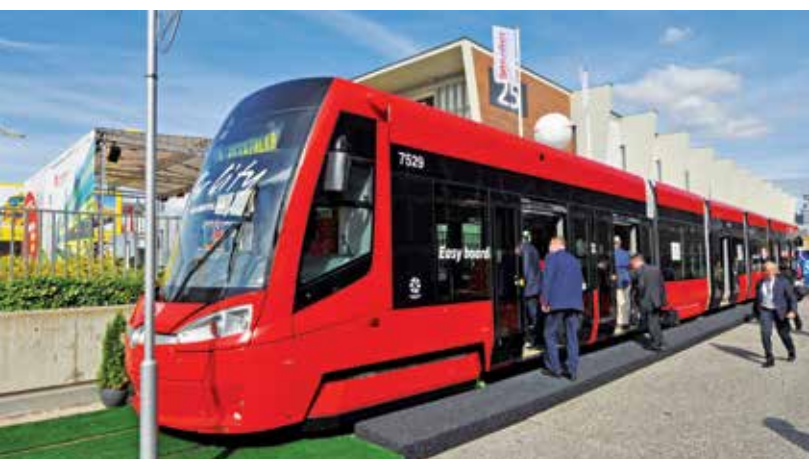
Tramwaj typu 30T ForCity Plus (Škoda) dla Bratysławy (1 000 mm)
