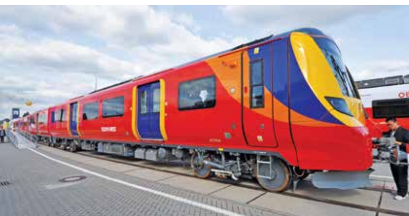
Desiro City (Siemens) dla brytyjskiego przewoźnika South West Trains (25 kV 50 Hz, 750 V DC)
