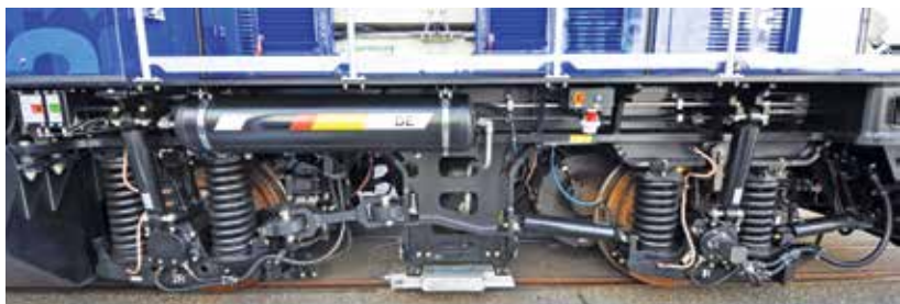
Wózek lokomotywy spalinowej/hybradowej Prima H3 (Alstom)
