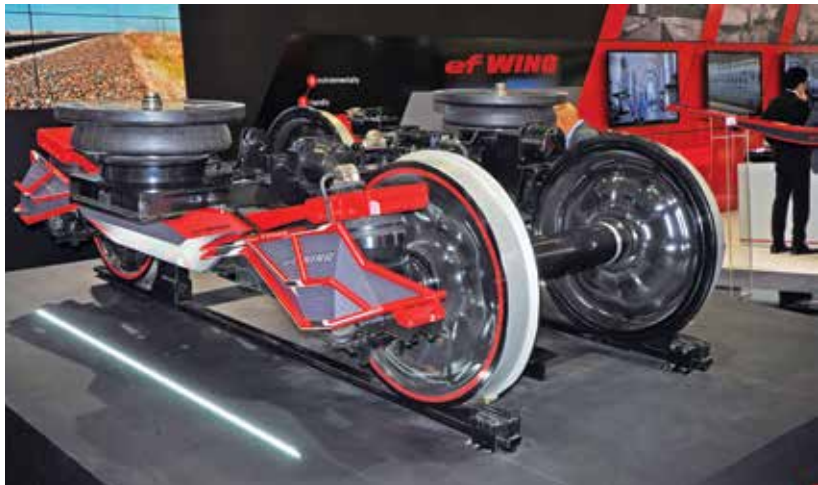
Wózek nowej generacji efWING firmy Kawasaki
