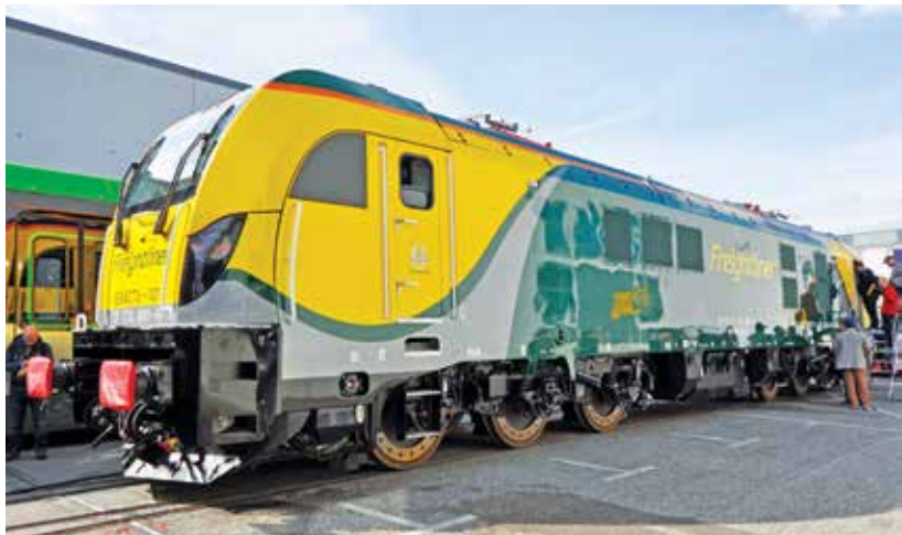
Lokomotywa elektryczna Dragon (Newag) serii E6ACTd (3 kV DC) dla przewoźnika Freightliner PL
