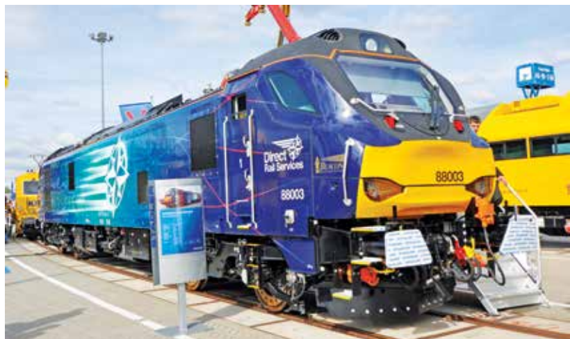
Lokomotywa elektryczna serii 88 (Stadler) dla Direct Rail Service/ Beacon Rail (25 kV 50 Hz)
