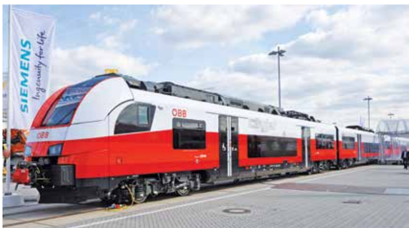
Zespoły Cityjet (Siemens) dla ÖBB (15 kV 16,7 Hz; 25 kV 50 Hz)
