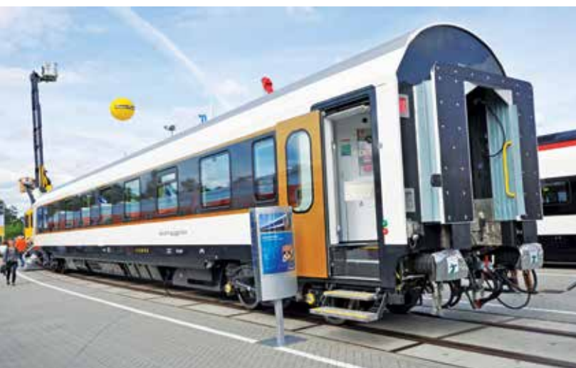
Wagon sypialny wykonany dla kolei Azerbejdżanu (Stadler) z wózkami ze zmiennym rozstawem kół (1 435/1 520 mm) typu DB AG/RAFIL V
