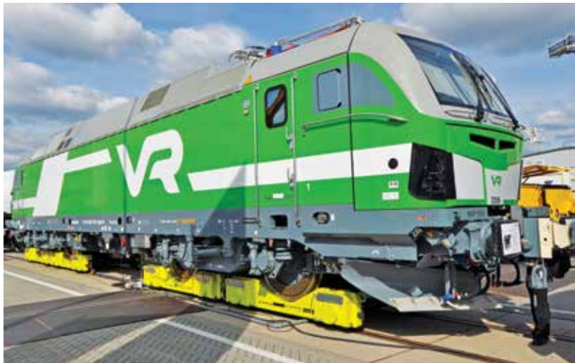
Lokomotywa elektryczna Vectron (Siemens) dla VR (1524 mm, 25 kV 50 Hz)
