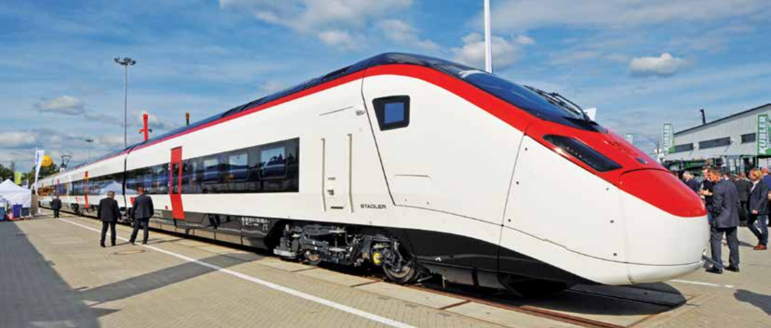
Elektryczny zespół dużych prędkości serii EC250 (Stadler) dla kolei szwajcarskich (15 kV 16,7 Hz; 25 kV 50 Hz i 3 kV DC)
