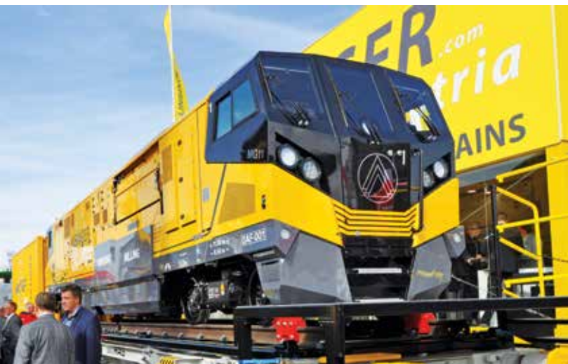
Pojazd serii MG11 przeznaczony do szlifowania oraz reprofilowania szyn firmy Linsinger
