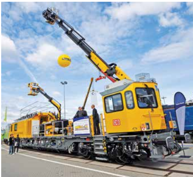
Pojazd przeznaczony do remontów infrastruktury kolejowej firmy Plasser&Theurer
