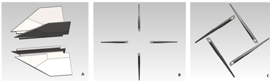
Rys. 6. Stateczniki II stopnia naddźwiękowej przeciwlotniczej rakiety A – rzut izometryczny, B – rozłożone, C – złożone
