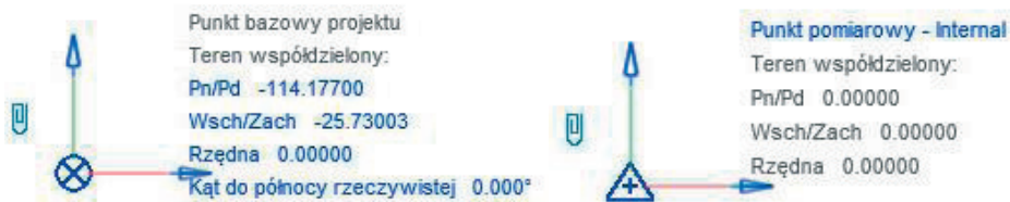
Rys. 6. Punkt bazowy projektu i punkt pomiarowy
