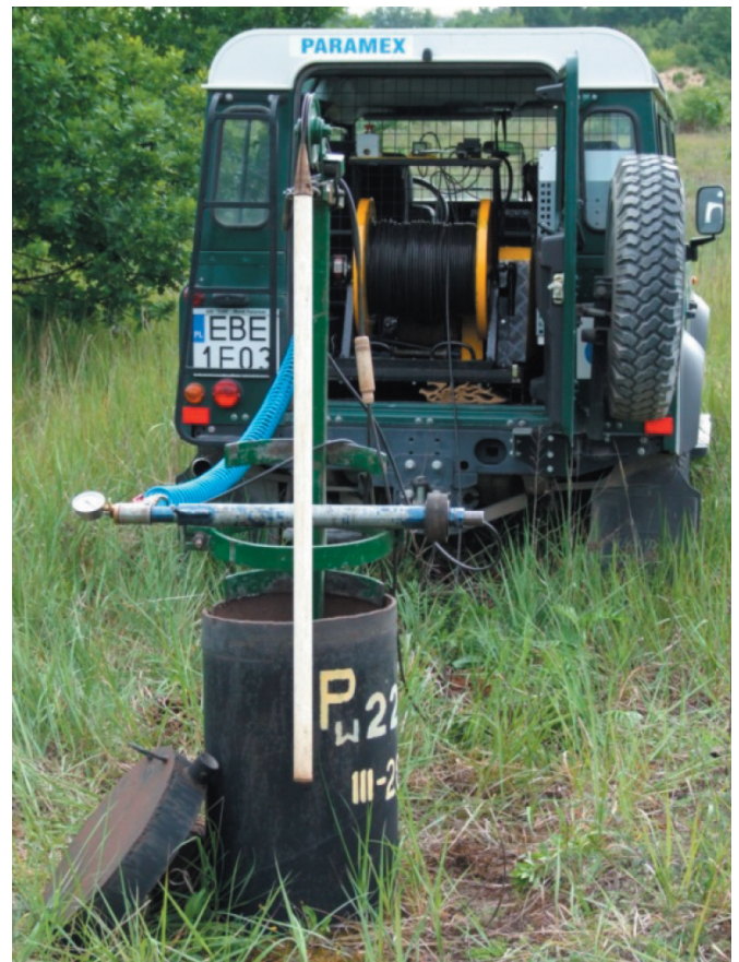
Fot. 3. Piezometr podczas badania metodą Paramex Fot. 3. Piezometer during research metod Paramex
