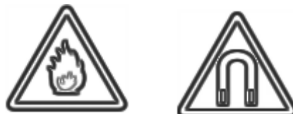
Rys. 4. Ikony przedstawiające sposób zaprezentowania informacji o zagrożeniach polem magnetycznym oraz zagrożenie oparami i dymami podczas spawania
