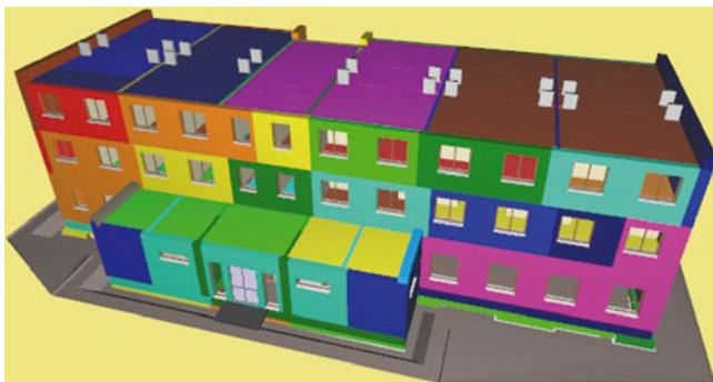
Rys. 3. Model 4D BIM z kolejnymi działkami roboczymi – obraz statyczny
