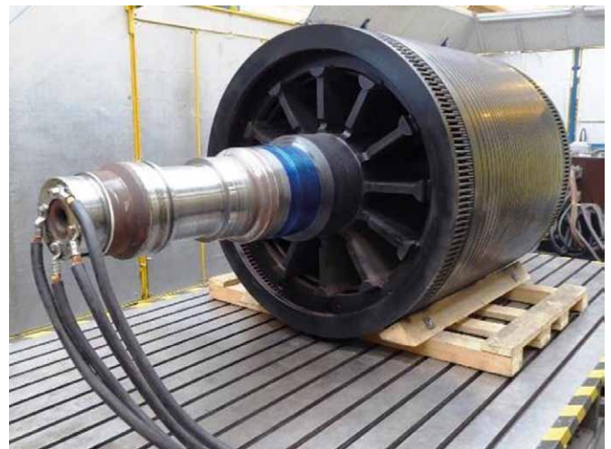
Rys. 29. Widok badanego wirnika z przewodami układu wymuszenia prądu w wale
