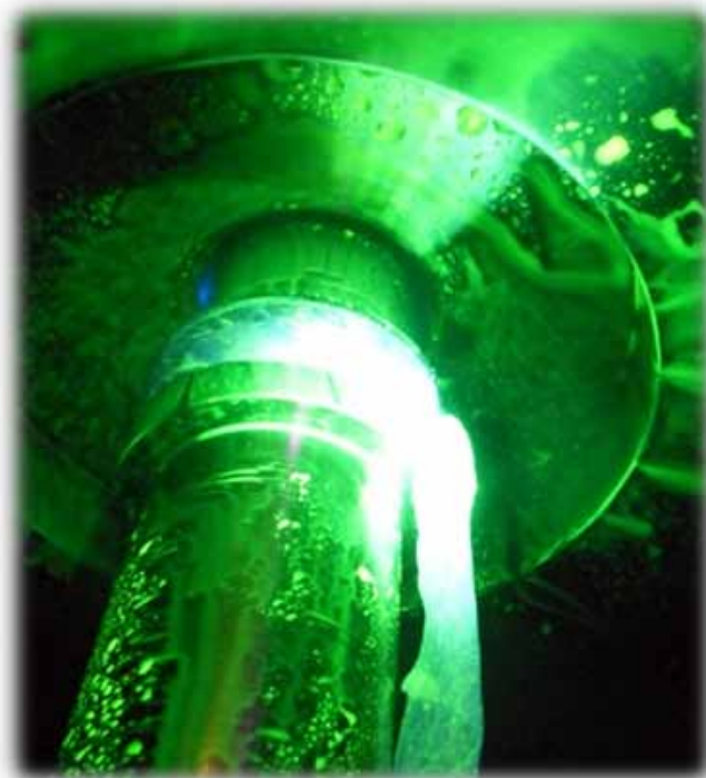
Rys. 2. Wybrany punkt kontrolny ZB_{m-2} – Wał mieszadła i osadzenie wału – Stan po naświetleniu substancji barwiącej [fotografia własna].
