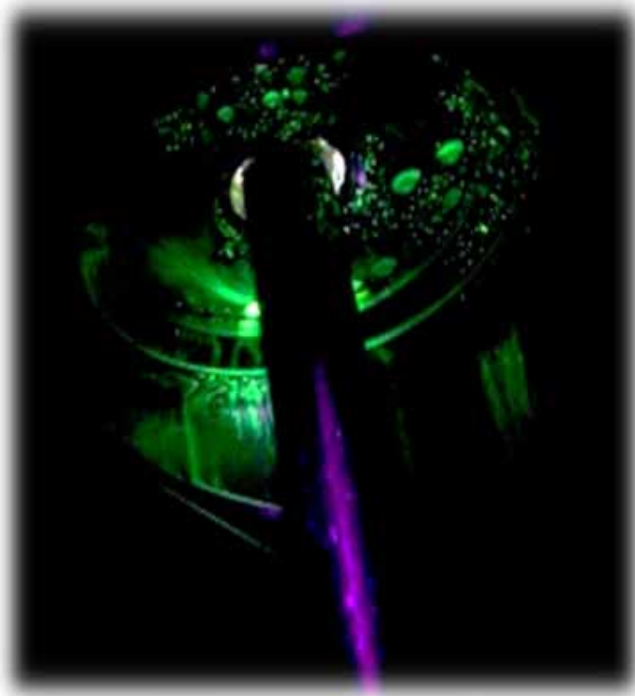
Rys. 3. Wybrany punkt kontrolny ZB_{m-2} – Wał mieszadła i osadzenie wału – Niepełne wypłukanie ryboflawiny [fotografia własna].
