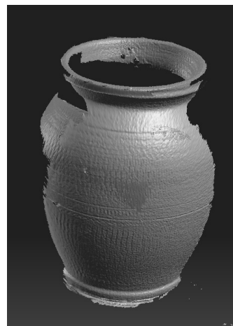
Rys. 2. Skan fragmentu obiektu, złożenie kilku skanów cząstkowych Fig. 2. Scan of a fragment of the object, combination of partial scans
