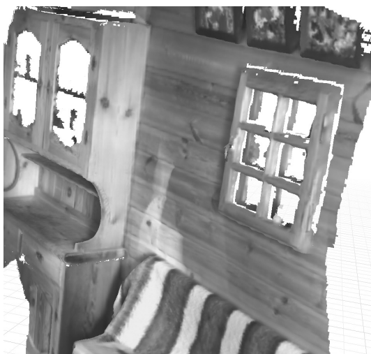
Rys. 1. Chmura punktów powierzchni otoczenia uzyskana sensorem Kinect Fig. 1. Point cloud acquired by Kinect
