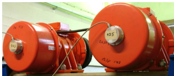
Rys. 5. Sposób zamocowania enkoderów inkrementalnych na modelowych elektrowibratorach z silnikami PMSM
