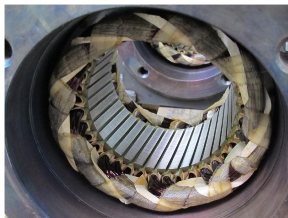
Rys. 2. Uzwojony stojan silnika PMSM osadzony w korpusie stalowym spawanym. Uzwojenie rozłożone quasi-sinusoidalnie, jednowarstwowe, 2 żłobki na biegun i fazę, skos żłobków stojana o pełną podziałkę żłobkową
