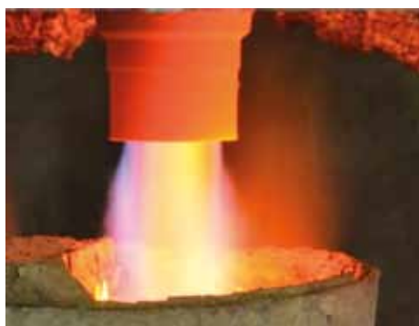
Rys. 9. Warunki pracy dyszy palnika o średnicy 100 mm do wygrzewania kadzi odlewniczej
