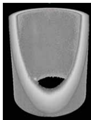
Rys. 12. Brak porowatości w odlewie dyszy DN100 ze stopu H282 zalewanego syfonowo:
