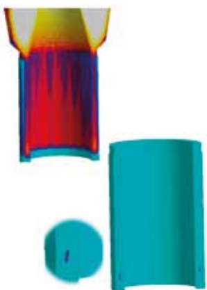
Rys. 11. Nieciągłości wewnętrzne odlewu dyszy DN100 ze stopu H282 zalewanego przez nadlew:
