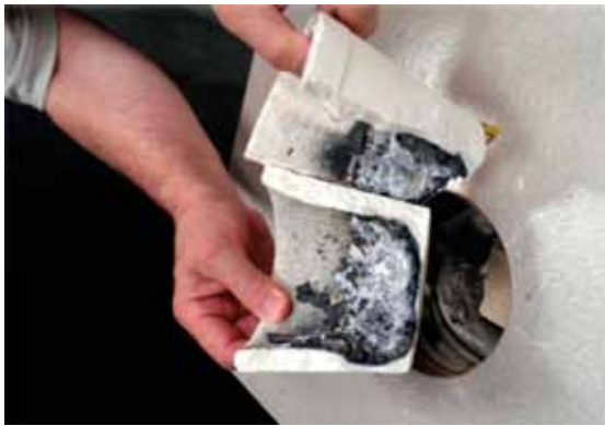
Rys. 13. Efekt reakcji ciekłego stopu IN740 z materiałem ceramicznym tygla laboratoryjnego pieca indukcyjnego
