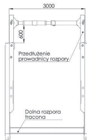
Rys. 3. Projekt zmodyfikowanego systemu STANDARDBOX 3,5 \times 2,4 \times 0,1 m z dodatkowym wyposażeniem
