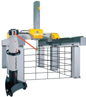
Rys.1. Realizacja metody macierzowej z wykorzystaniem Laserowego Systemu Nadążnego LSW 840 Leica Fig. 1. Realization of Matrix Method with the use of Lasertracker LTD840 Leica
