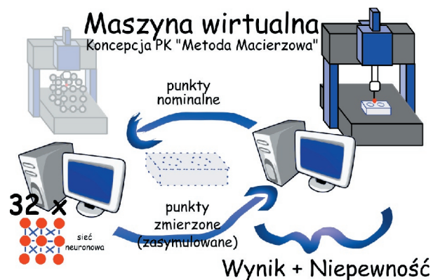
Rys. 5. Koncepcja VCMM PK opracowana w PK z wykorzystaniem sztucznych sieci neuronowych i Metody Macierzowej identyfikacji dokładności w punktach referencyjnych [1,4]
