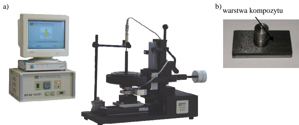
Rys. 1. Widok testera tribologicznego T-17 (a) i skojarzenia badawczego (b) Fig. 1. The view of T-17 tribotester (a) and tribosystem (b)
