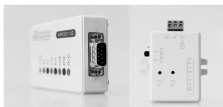
Rys. 4. Konwerter USB 2.0-RS232 z izolacją galwaniczną – po lewej; konwerter USB-RS485 z izolacją galwaniczną – po prawej Fig. 4. Galvanic separated converters USB 2.0-RS232 (left), USB-RS485 (right)
