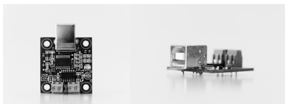
Rys. 5. Moduł konwertera USB – RS485, transmisja half-duplex Fig. 5. USB – RS485 converting module, half-duplex transmission
