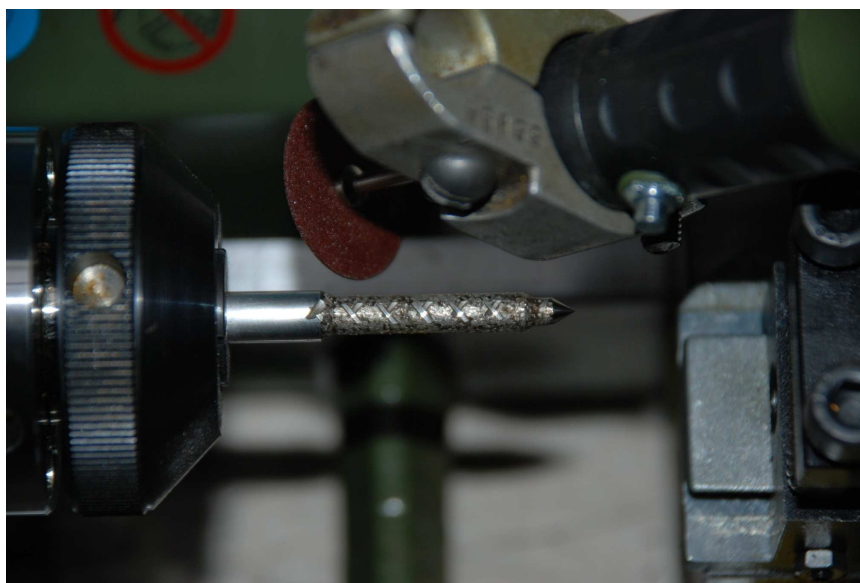
Rys. 4. Stanowisko do wykonania kanałów turbulizacyjnych na rozpylaczach ze wstępną obróbką paliwa
