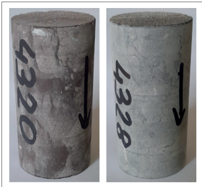
Rysunek 2. Wybrane próbki rdzeniowe wapieni wycięte do badań Figure 2. Selected limestone core samples used in the tests
