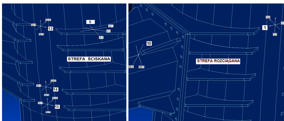
Rys. 2. Rozmieszczenie czujników tensometrycznych na słupie [autor]
