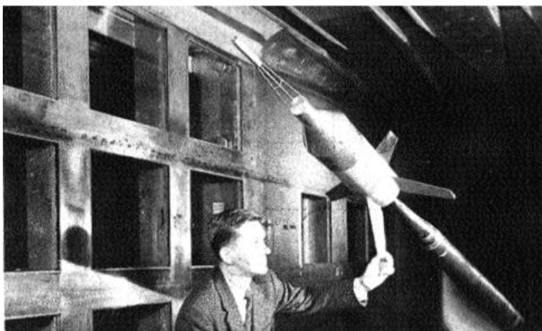
Rys. 7. Badanie na wadze „żądłowej” modelu pocisku w laboratorium NASA [7]
