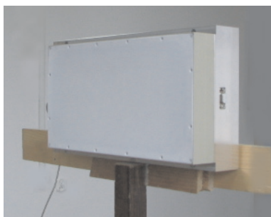
Rys. 4. Zdjęcia anteny wraz z blokiem sterowania wiązką podczas próbnych pomiarów
