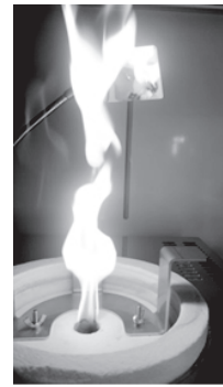
Fig. 5 Minimum autoignition temperature at 50 µl sample volume for acetone Rys. 5 Minimalna temperatura samozapłonu przy objętości próbki 50 µl dla acetonu
