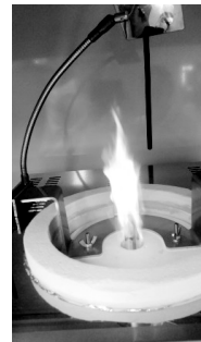
Fig. 5 Minimum autoignition temperature at 50 µl sample volume for acetone Rys. 5 Minimalna temperatura samozapłonu przy objętości próbki 50 µl dla acetonu
