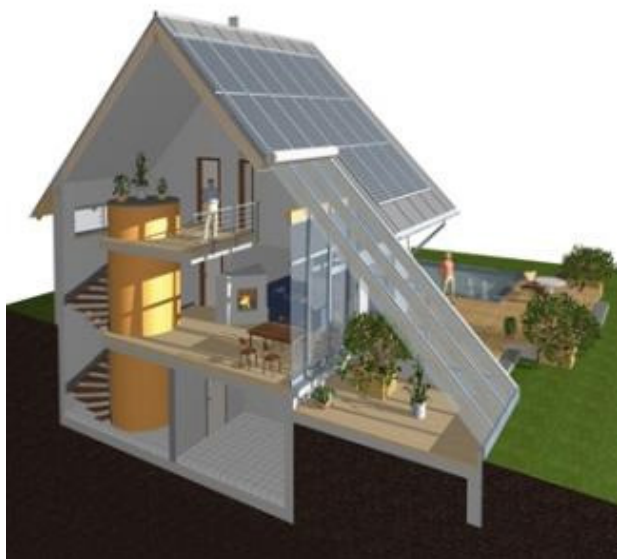
Rys. 5. Dom słoneczny – uwagę zwraca bardzo duży żółty zasobnik wewnątrz budynku (źródło: Sonnenhaus-Institut e.V.)
