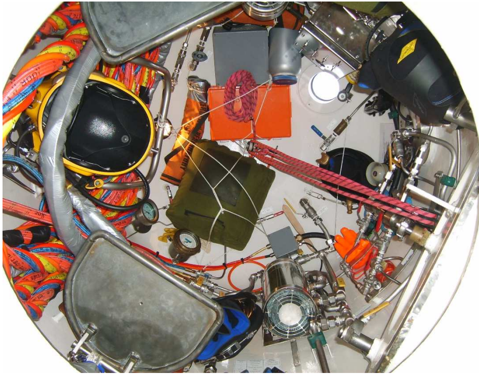
Rys. 5 Wyposażenie dzwonu nurkowego Af-2 widziane z wlotu wejściowego.(zdjęcie z 2016 r.). Węże widoczne i spód hełmu to sprzęt nurka roboczego.
