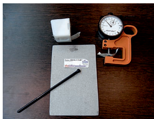
Rys. 4. Pomiar za pomocą taśmy replikacyjnej. Fig. 4. Measurement with replica tape.
