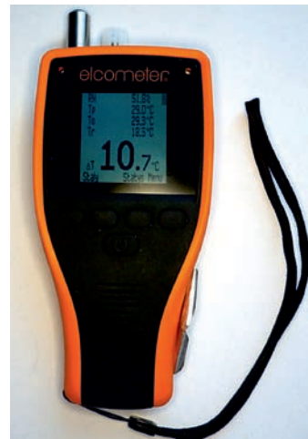
Rys. 6. Urządzenia do kontroli warunków klimatycznych elektroniczne. Fig. 6. Electronical climate control device.
