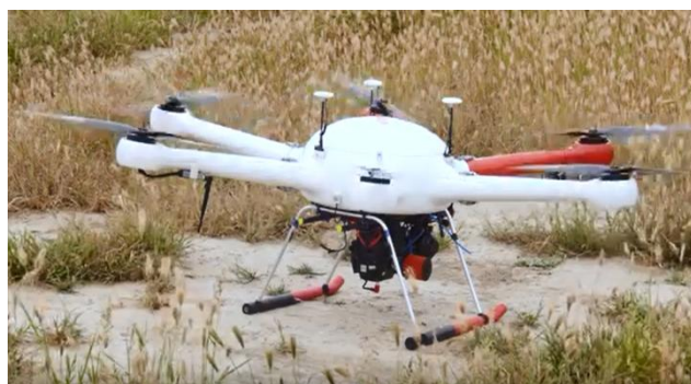
Rys. 7 Hexacopter wyposażony w hybrydowy układ zasilania. Foxtech FPV [15]
