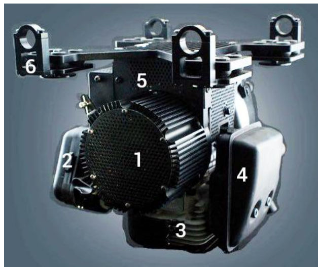
Rys. 6 Agregat prądowłórczy dla zastosowań w BSP; 1-generator, 2-gaźnik, 3- dwusuwowy silnik spalinowy, 4-tłumik wydechowy, 5-mikroprocesorowy układ kontrolno-sterujący, 6-antywibracyjne mocowanie do ramy BSP[17]
