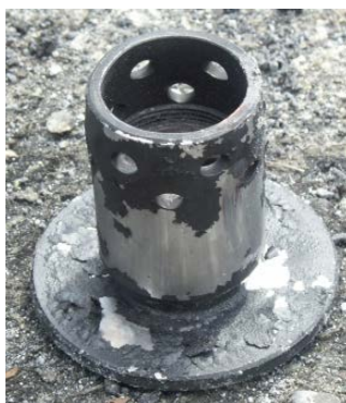
Fot. 6 Zespół tłumiący wypływ gazów Źródło: [5]
