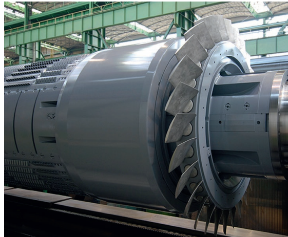
Fot. 1. Wirnik turbogeneratorskiego z zabierakowymi klinami żłobkowymi i nowym wentylatorem osadzonym na wale
