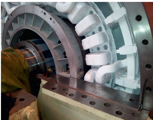
Fot. 3. Nowa osłona wentylatora wirnika z tylnymi łopatkami kierowniczym
