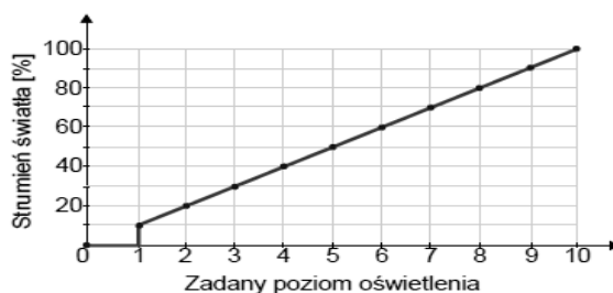
Rys. 9. Regulacja liniowa strumienia świetlnego w lampach LED [10]
