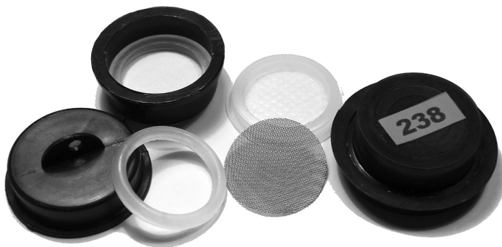
Rys. 1. Próbniki pasywne (PN-98 Z-04092/08)
