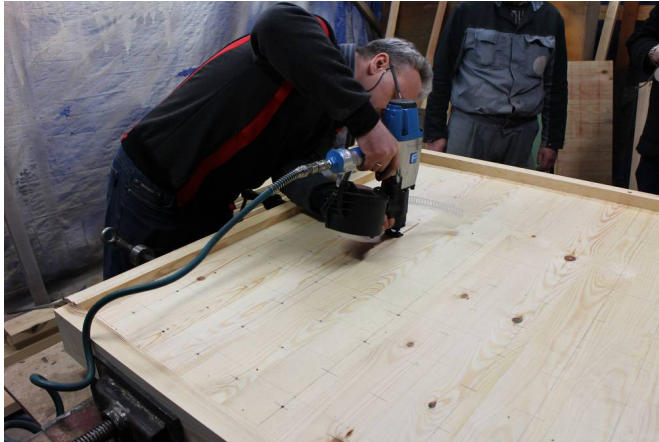
Rys. 2. Przygotowanie płyty CLT do badań. Wstrzeliwanie gwoździ kompozytowych za pomocą gwoździarki pneumatycznej [fot. własna]
