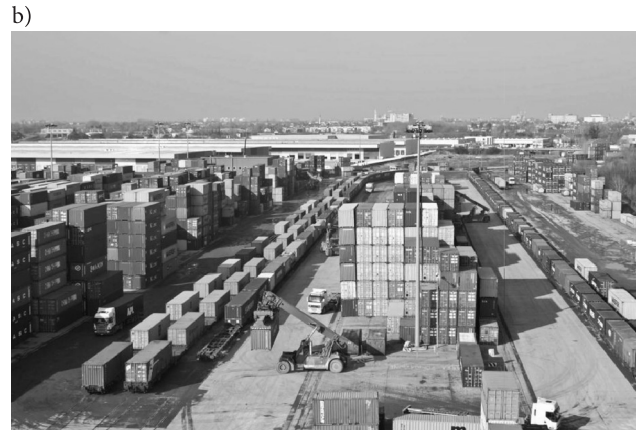
Rys. 1. Pasma składowe kontenerów: a) na podsuwnicowym placu składowym, b) na terminalu przeładunkowym obsługiwany przez wozy podnośnikowe [Źródło: www.cargo-center-graz.at.; www.Interporti di Padova]
