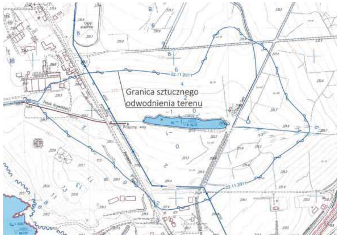
Rys. 4. Granica sztucznego odwodnienia terenu w zlewni potoku Krywałdzkiego
