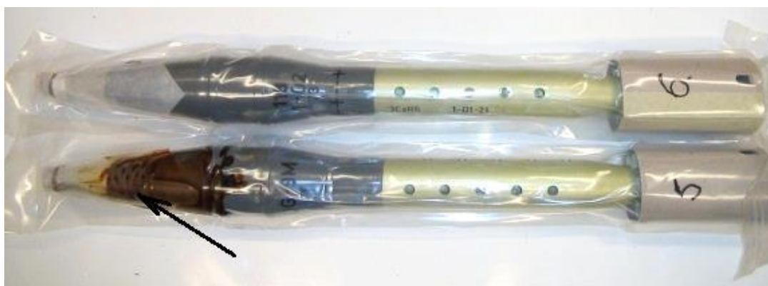
Fot. 1. Olej trotylowy na powierzchni pocisku OG-9 zapakowanego w hermetyczne opakowanie foliowe. (Źródło: opracowanie własne WITU)
