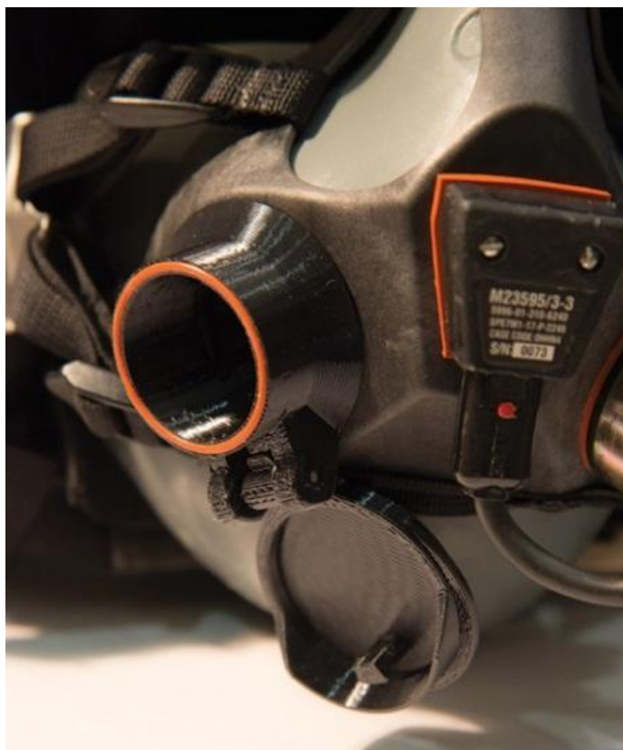
Rys. 1. Wydrukowany zawór typu flip-top wykorzystywany w masce tlenowej samolotu szkolnego 45 Goshawk
