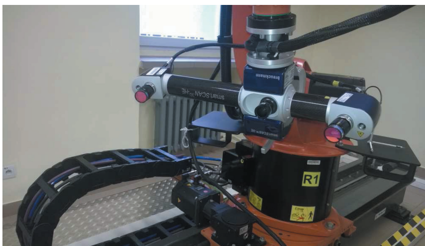
Rys. 4. Skaner metrologiczny światła strukturalnego smartSCAN 3D-HE zamocowany do ramienia robota
