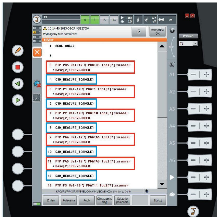
Rys. 7. Widok fragmentu programu pomiarowego w języku KRL na wyświetlaczu panelu programowania robota Fig. 7. View of part of measuring programme in KRL language on the robot's programming panel display
