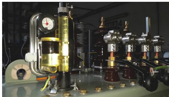
Fot. 3. Zabezpieczenie gazowo-ciśnieniowo-temperaturowe dławika kompensacyjnego z uzwojeniem potrzeb własnych w wersji hermetycznej
