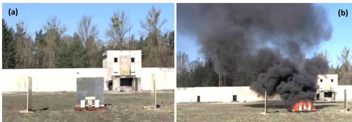
Rys. 3. (a) Stanowisko do badania odporności na działanie ognia. (b) Brak niebezpiecznych efektów w trakcie palenia opakowań transportowych próbek trotylu naniesionych na nośnik stały
