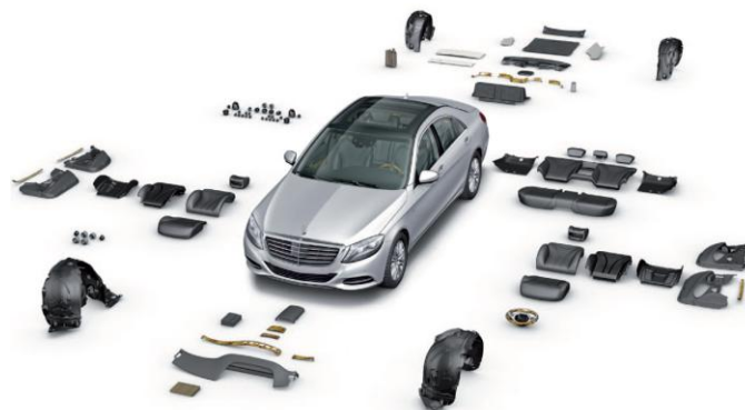
Rys. 5. Elementy samochodu Mercedes S 400 HYBRID wykonane z zastosowaniem materiałów naturalnych [16]
