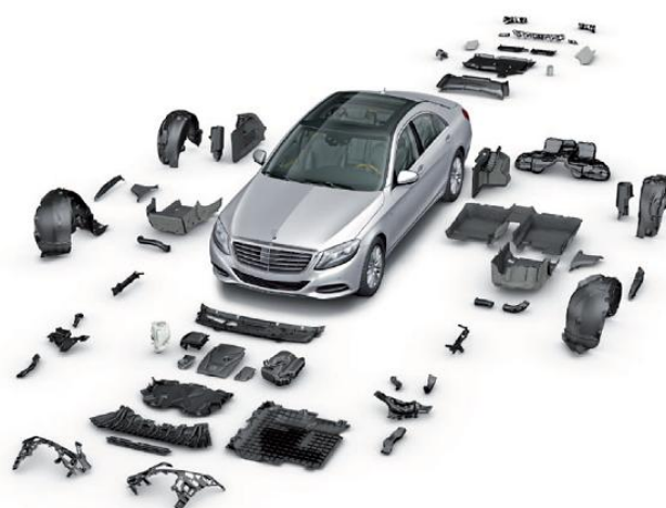
Rys. 3. Elementy samochodu Mercedes S 400 HYBRID wykonane z materiałów pochodzących z recyklingu [16]
