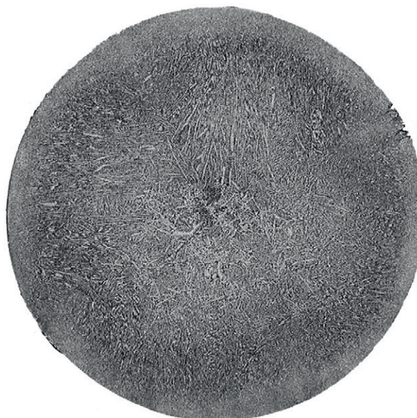
Rys. 23. Makrostruktura uzyskana po głębokim trawieniu powierzchni przekroju poprzecznego pręta o średnicy 52 mm odwalcowanego z wlewka ciągłego o przekroju 160 mm × 160 mm (stopień przerobu plastycznego 12) ze stali zawierającej 0,18% C i 1,25% Mn
