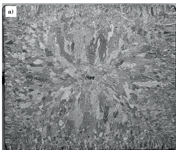
Rys. 10. Obrazy makrostruktury na przekroju poprzecznym wlewka ciągłego o wymiarach 165 mm × 140 mm ze stali zawierającej 0,17% C, 0,69% Mn i 0,28% Mo: a) trawienie ujawniające głównie strukturę ziarnową pierwotnego austenitu, b) trawienie ujawniające strukturę dendrytyczną nałożoną na strukturę ziarnową pierwotnego austenitu
