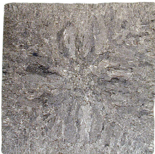
Rys. 9. Obraz makrostruktury wlewka ciągłego ze stali zawierającej 0,09% C, 0,57% Mn, 0,013% P oraz 0,002% S, o wymiarach poprzecznych 160 mm × 160 mm, uzyskany na płaszczyźnie prostopadłej do osi wlewka w wyniku głębokiego trawienia
