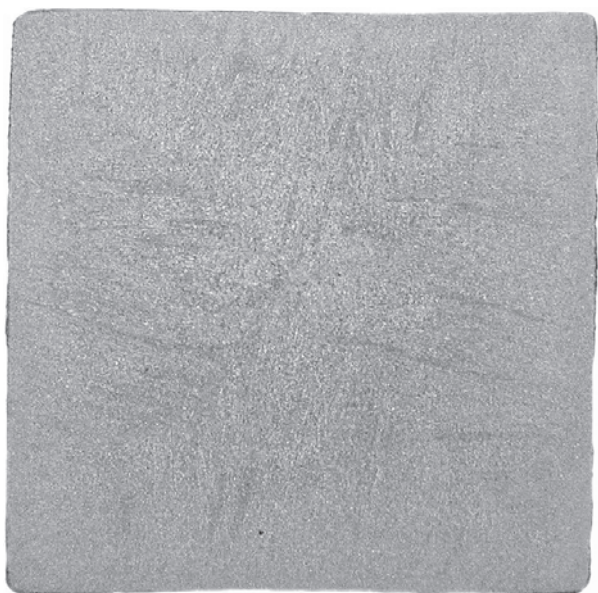
Rys. 13. Obraz makrostruktury wlewka ciągłego ze stali zawierającej 0,74% C, 1,06% Mn, 0,013% P, 0,023% S, o wymiarach poprzecznych 140 mm × 140, uzyskany na płaszczyźnie prostopadłej do osi wlewka w wyniku głębokiego trawienia
