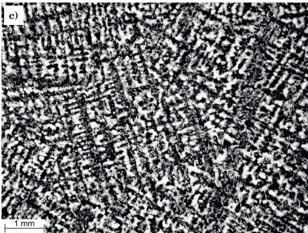
Rys. 15 cd. Struktura dendrytyczna ujawniona w wyniku wytrawienia odczynnikiem Oberhoffera na przekroju wlewka, którego obraz makrostruktury zamieszczono na rys. 13: a) warstwa przypowierzchniowa, b) strefa pośrednia, c) strefa środkowa
