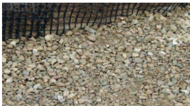
Rys. 3. Kruszywo „kruszone” pozyskiwane z materiału miejscowego regonu Warmii i Mazur. Widoczne zróżnicowanie petrograficzne (źródło własne)
