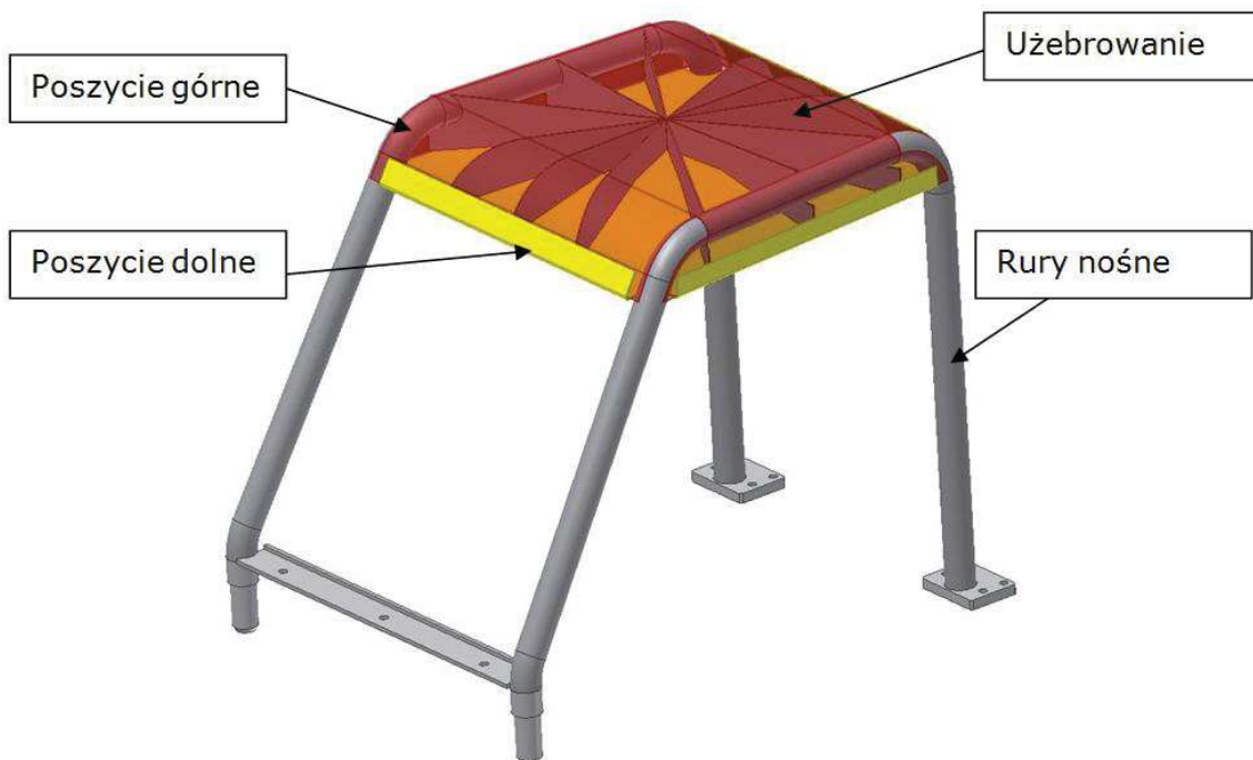
Rys. 2. Model przestrzenny poszycia dachu kabiny operatora [1]
