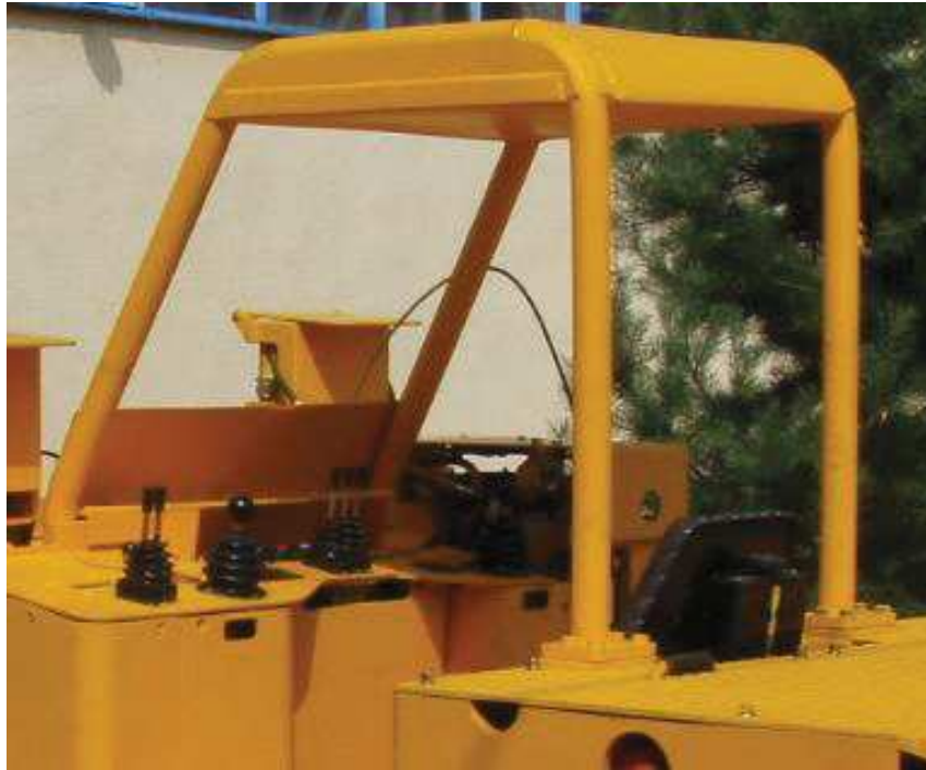
Rys. 1. Konstrukcja ochronna operatora ładowarki ŁBT 1200M [opracowanie własne]
