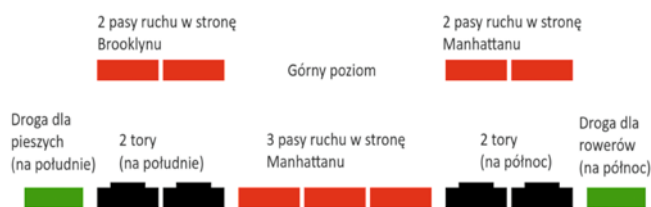
Szkic obrazujący rozkład jezdni i torowisk na moście Manhattan
