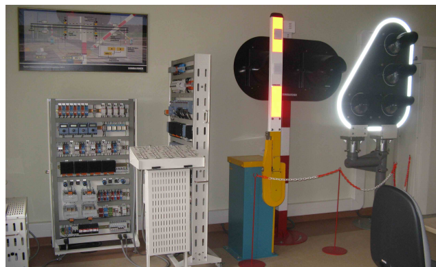
Fot. 3. Widok ogólny stanowiska samoczynnej sygnalizacji przejazdowej typu SPA-5 produkcji Bombardier Transportation (ZWUS) Polska
