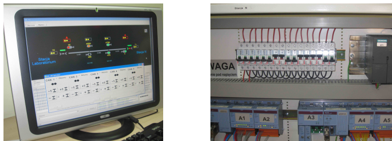
Fot. 2. Wygląd symulatora blokady SHL-12 i styczników wpływających na zachowanie się urządzeń srk na stacji N w logicznym połączeniu z blokadą liniową SHL-12 zaprojektowanych pod potrzeby Laboratorium Systemów Sterowania Ruchem Kolejowym
