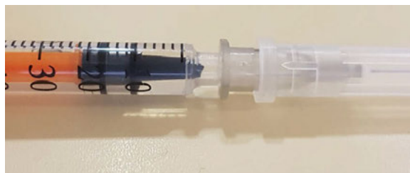
Rys. 5 Źródło punktowe w strzykawce Źródło: Materiał własny.
