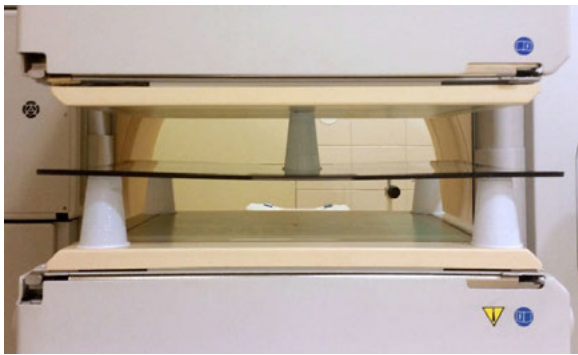
Rys. 6 Ułożenie źródła płaskiego ^{57}\text{Co} w teście jednorodności zewnętrznej jednocześnie dla dwóch detektorów z zachowaniem odległości źródło-detektor przynajmniej 10 cm Źródło: Materiał własny.
