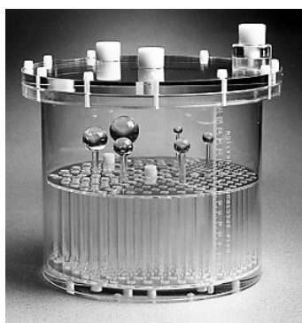
Rys. 16 Fantom Jaszczaka do oceny ogólnej wydajności systemu SPECT składający się z jednorodnej sekcji, prętów oraz sfer Źródło: [21].
