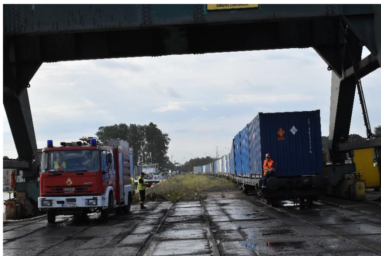
Rys. 4. Transport kolejowy z kontenerami z materiałami wybuchowymi i zabezpieczeniem ppoż. na stanowisku przeładunkowym. Źródło: Archiwum foto archiwum autora.
