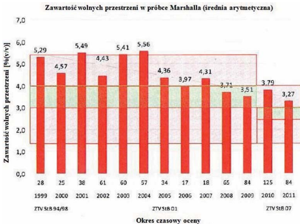
Rys. 5. Zawartość wolnych przestrzeni oznaczona w okresie rocznym określona na próbach Marshalla uformowanych z mieszanki SMA 8 S
