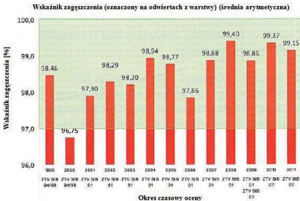
Rys. 9. Wskaźnik zagęszczenia w okresie rocznym oznaczony w mieszance SMA 8 S
