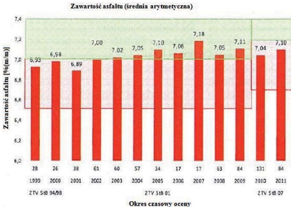
Rys. 1. Zawartości asfaltu w okresie rocznym oznaczone w mieszance SMA 8 S
