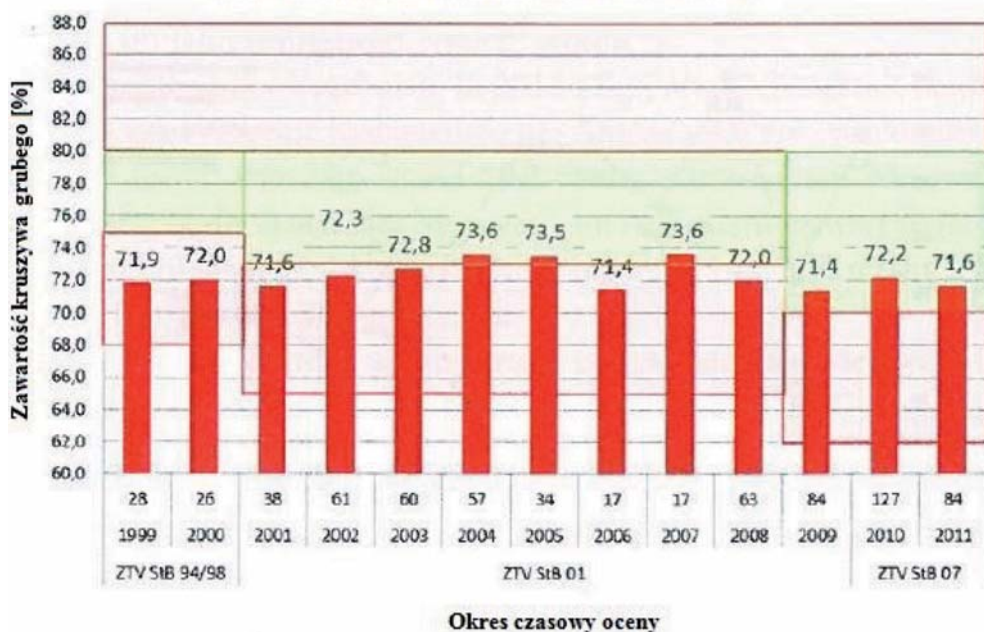
Rys. 3. Zawartości kruszywa grubego oznaczone w okresie rocznym w mieszance SMA 8 S
